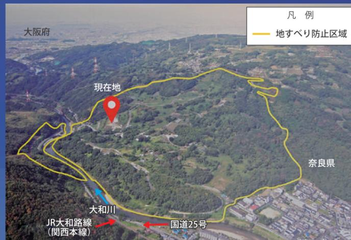
し奈良県側で氾濫、旧国鉄・関西本線のトンネル東口が崩壊しました。昭和6年11月に活動を始めた地すべりでは、翌7年に地すべりが活発化して旧国鉄の亀の瀬トンネルが崩壊。また、昭和7年7月の豪雨時には大和川の河床が9m以上隆起して完全に閉塞、上流で浸水被害が発生しました。現在の大和川は、このときに左岸側に新たに掘削したもので、鉄道も地すべりを迂回して現在のルートの左岸側に新設されました。昭和42年にも、水平26m移動し大和川の川幅が1m狭まっています。
